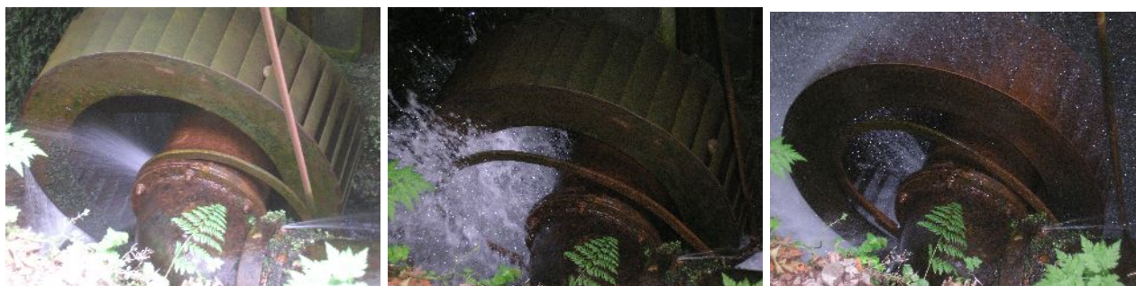
Figure 2. Turbine à l'arrêt (gauche), en phase de démarrage (début d'arrivée d'eau, centre) et en rotation (droite)
