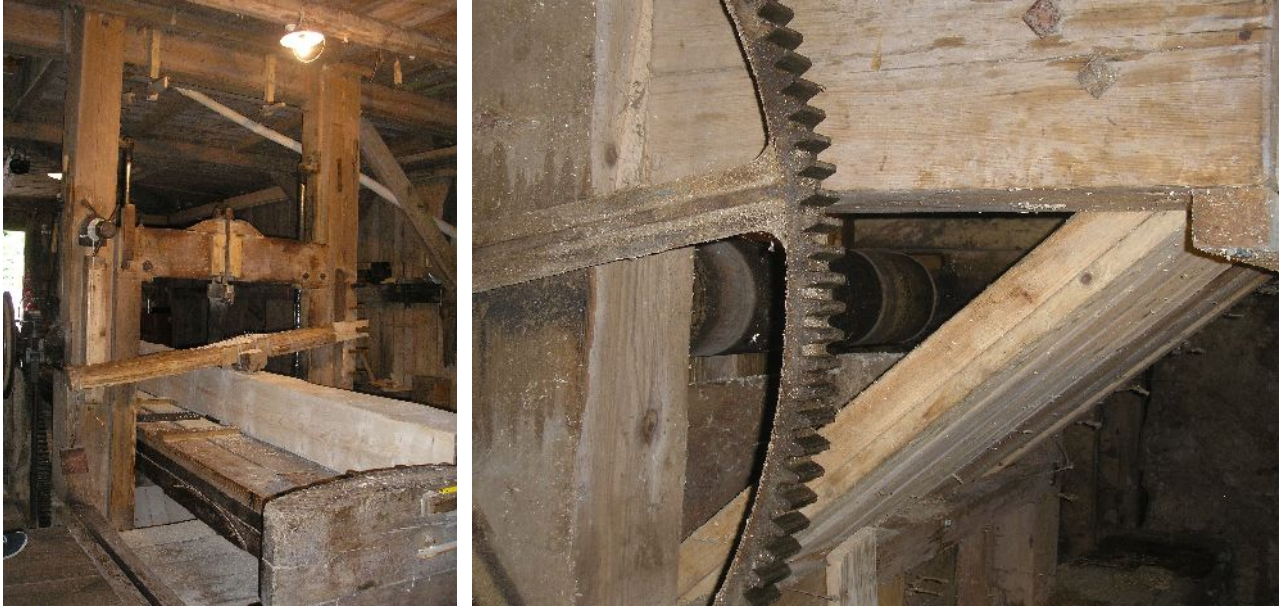
Figure 5. Gauche : Haut du cadre de scie, table de coupe et levier pression et de détection de fin de course de la table de coupe. Droite : roue dentée et rouleau du mécanisme d'avancement de la table de coupe.
