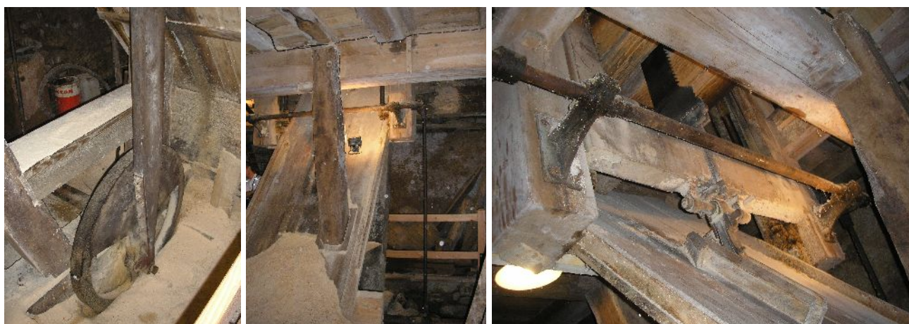
Figure 4. Mécanisme d'entraînement de la scie. Gauche: Roue à contrepoids et excentrique d'entraînement de la bielle de commande de la scie. Centre : bielle et axe de renvoi du mécanisme d'avancement de la table de coupe; plan incliné d'évacuation de la sciure. Droite : bas du cadre de scie, jonction avec la bielle de commande de la scie, axe de renvoi du mécanisme d'avancement de la table de coupe et plan incliné d'évacuation de la sciure
