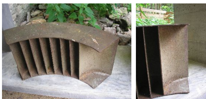
Figure 3. Détail d'une turbine réalisée comme modèle avant rénovation complète de la turbine en place
